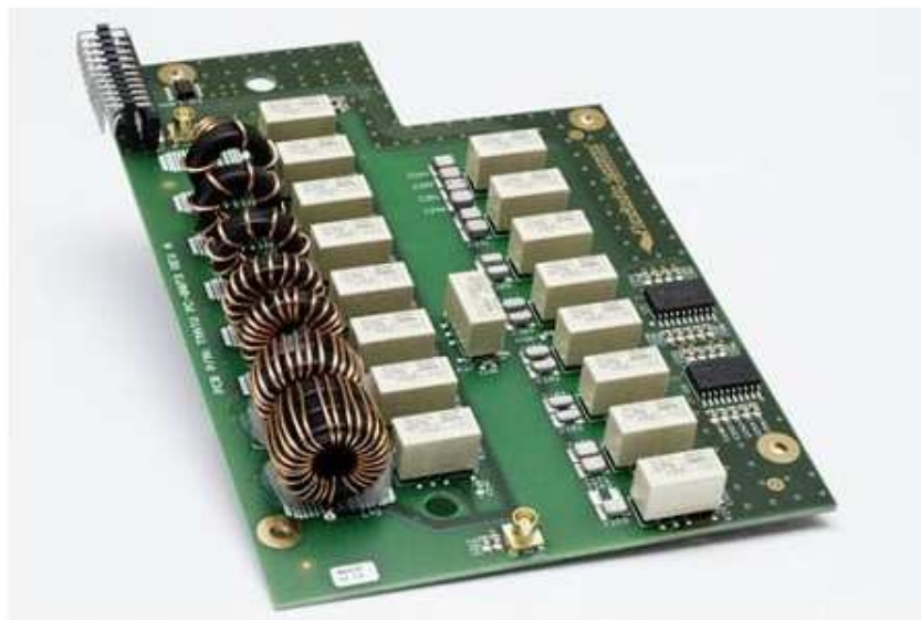
Fot. 7.4. Automatyczna skrzynka antenowa
