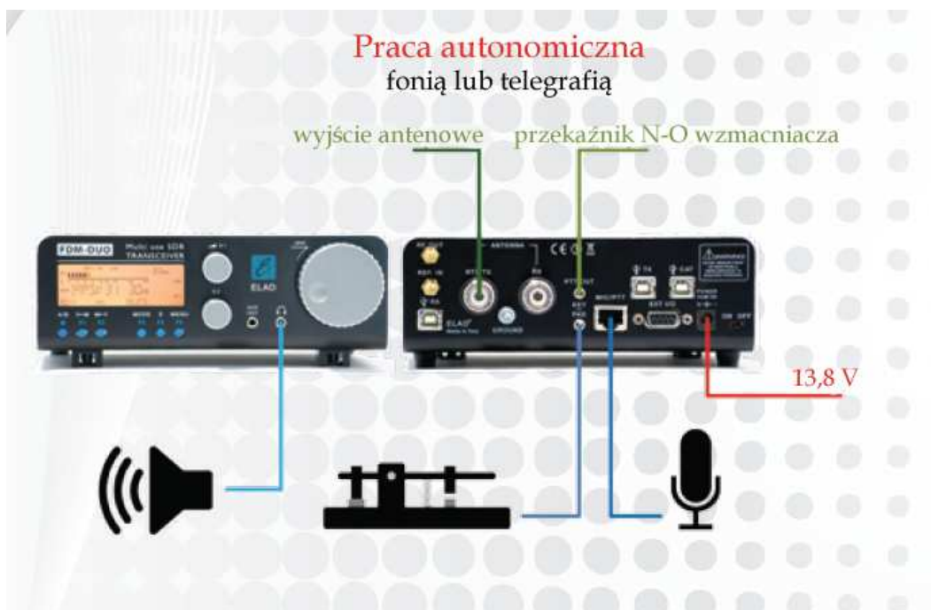
Rys. 8.3. Połączenia przy pracy autonomicznej fonią lub telegrafią
