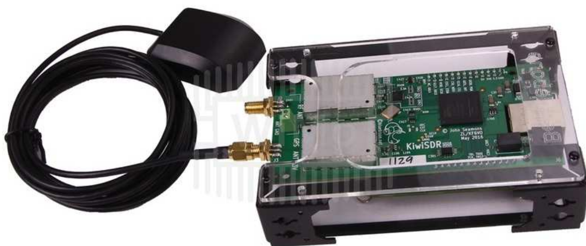
Fot. 5.1.1. Odbiornik we wspólnej obudowie z minikomputerem (zdjęcie: Wimo)
