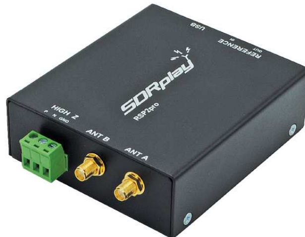
Fot. 1.5.2. RSP2pro – widok od frontu. Na tylnej ścianie oprócz gniazdka USB znajdują się dwa gniazdko MCX – wejściowe dla sygnału wzorcowego i wyjściowe generatora sterującego
