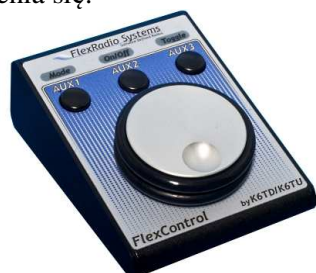
Fot 7.9. Gałka Flexcontrol ułatwia strojenie
