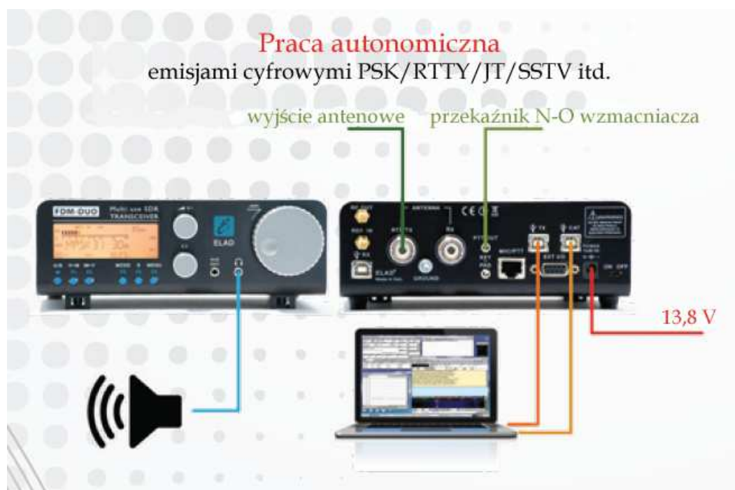
Rys. 8.4. Połączenia przy pracy autonomicznej emisjami cyfrowymi PSK/RTTY/JT/SSTV itd.
