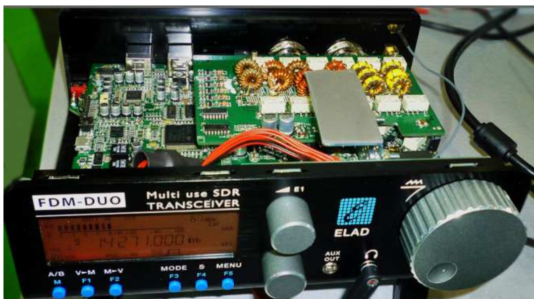
Fot. 8.7. Konstrukcja wewnętrzna i płyta czołowa
