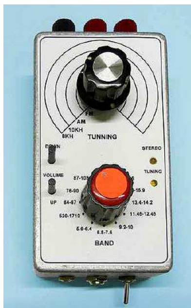
Rys. A.2. Przykład konstrukcji mechanicznej 12-zakresowego odbiornika PE1KTH (Funkamateurl1/2016)
