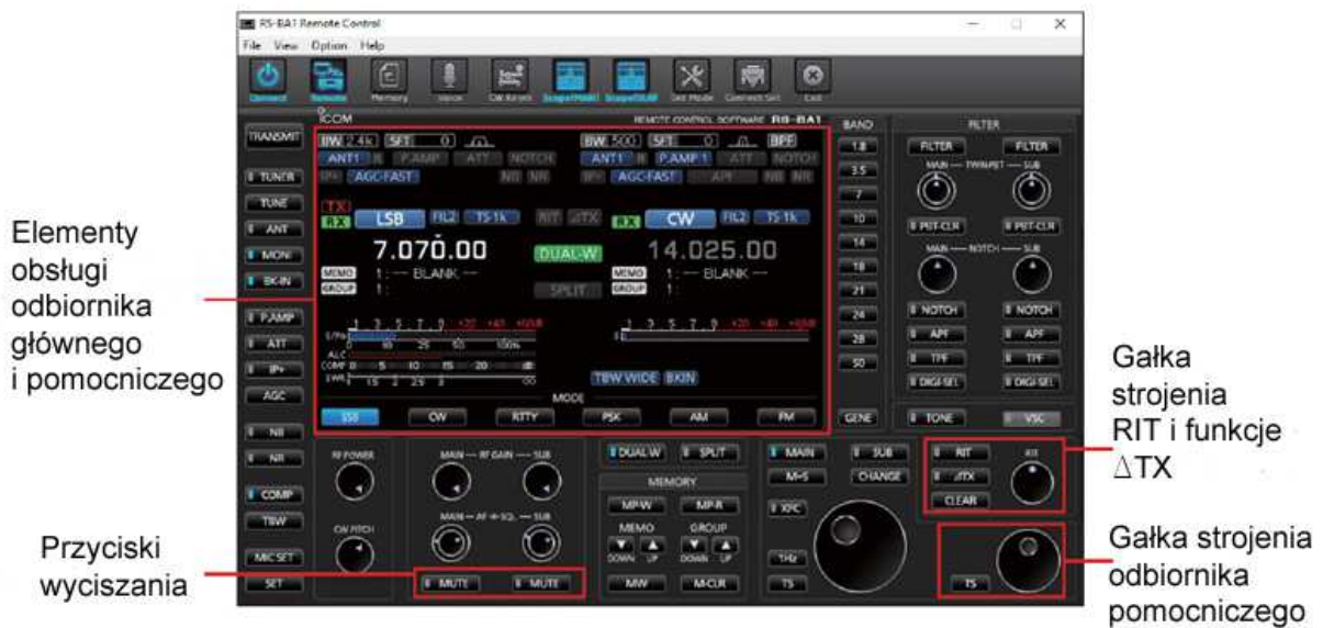
Fot. 9.4. Okno główne programu RS-BA1 (w wersji 2) do zdalnej obsługi radiostacji Icoma w sieci lokalnej lub przez Internet. Na czerwono wyróżnione funkcje dodatkowe w stosunku do wersji 1
