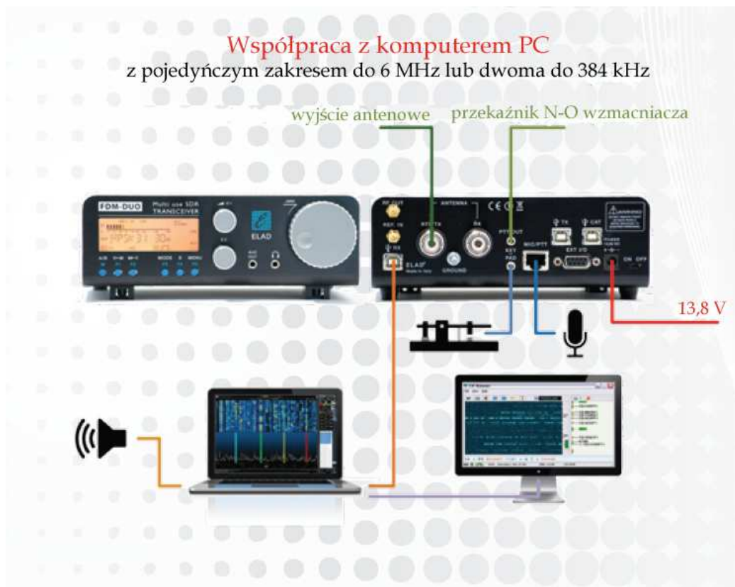
Rys. 8.5. Połączenia przy współpracy z komputerem z pojedynczym zakresem do 6 MHz lub z dwoma do 384 kHz
