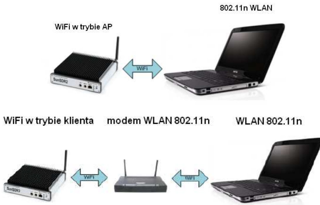
Rys. 6.8. Sposoby połączenia SDR2 w sieci domowej. Domyślnie adres IP wynosi 192.168.16.200 w trybie bezpośrednim, w trybie sieciowym jest przyznawany automatycznie w sieci lokalnej
